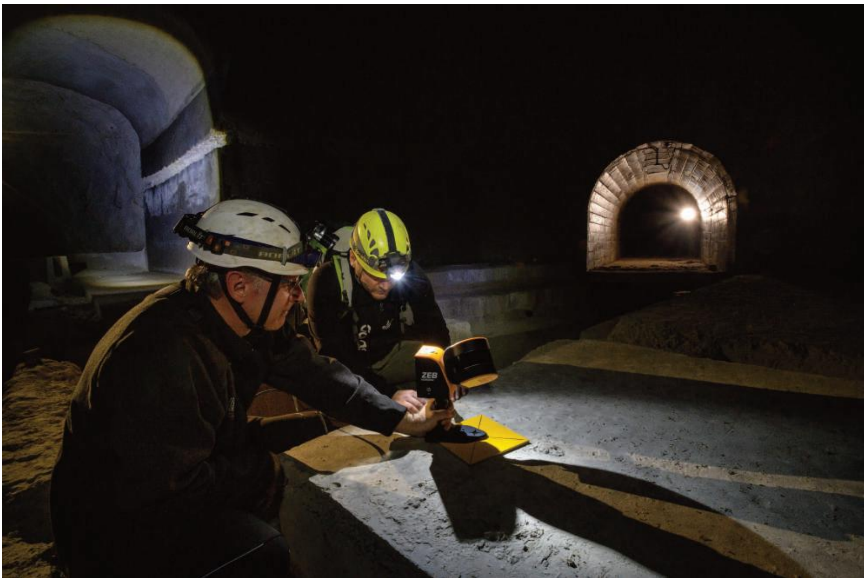
Fig. 4. Attività di rilievo con il laser scanner nella “Galleria superiore” (foto N. Paolantonio).
