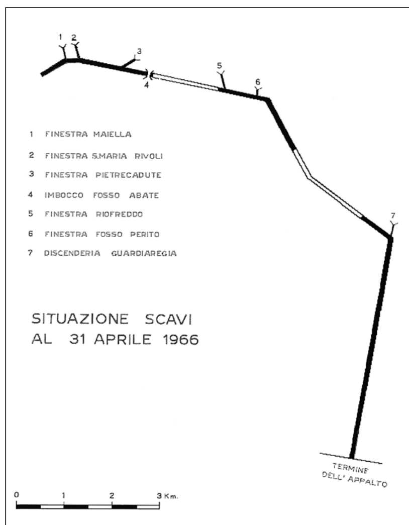
Fig. 15. Pianta dello stato di avanzamento dei lavori del 1° lotto della "Galleria di valico" (tratto da Cass. Mez., 1966).
