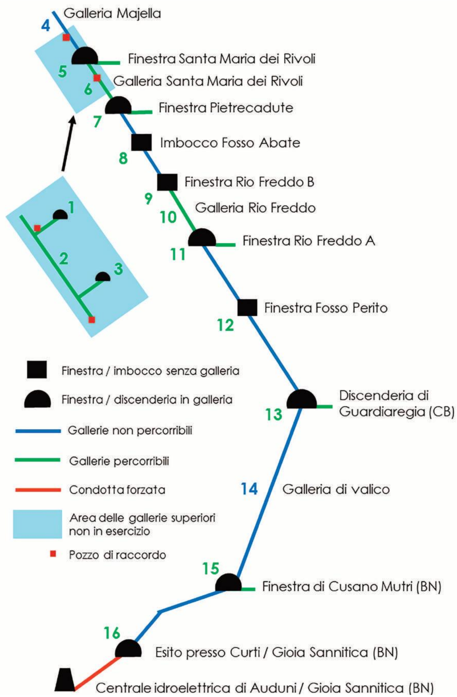
Fig. 24b. Rappresentazione schematica della rete di gallerie e accessi (disegno M. Mancini). Schematic representation of the network of tunnels and accesses (drawing M. Mancini).
