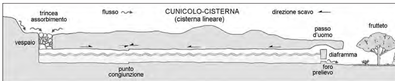
Fig. 9 – Schema di un cunicolo-cisterna lineare, con trincea di assorbimento/vespaio a Göreme (Cappadocia, Turchia) (grafica R. Bixio da: Galeazzi C. et al., 2020).
