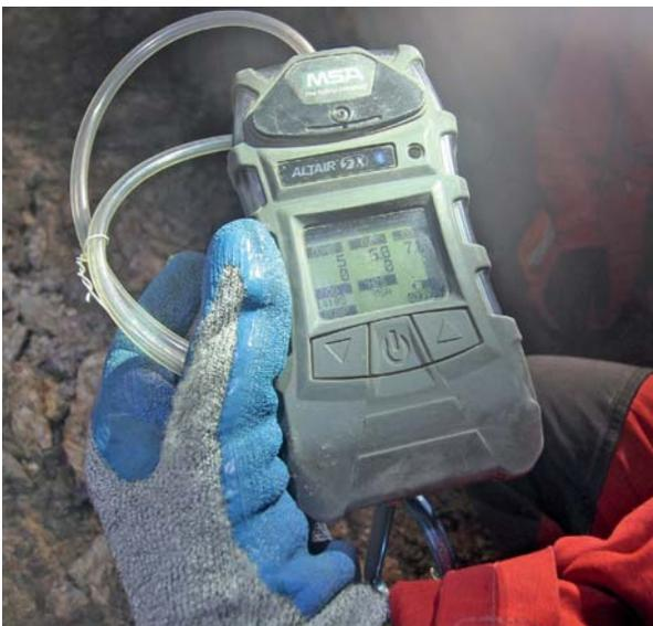
Fig. 6 – Miniera di Perticara, rilevatore di gas MSA Altair 5x, Gas esplosivi 5% del LEL, Ossigeno 5%, Diossido di carbonio 7.3% (foto M. Martellotta)
