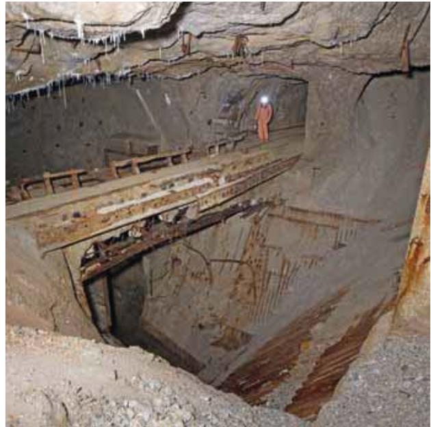
Fig. 16 – Miniera di Salafossa: il fornellone – silo principale della miniera, comune ai livelli di vagonaggio 1120, 1134 e 1154 (foto A. Riva).
