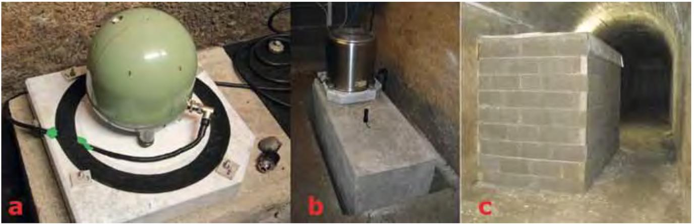
Fig. 1 – Stazione sismica nel Monte Soratte (RM): a) sismometro VBB b) plinto e schermatura c) galleria e casottino per strumentazione (foto P. Casale).
