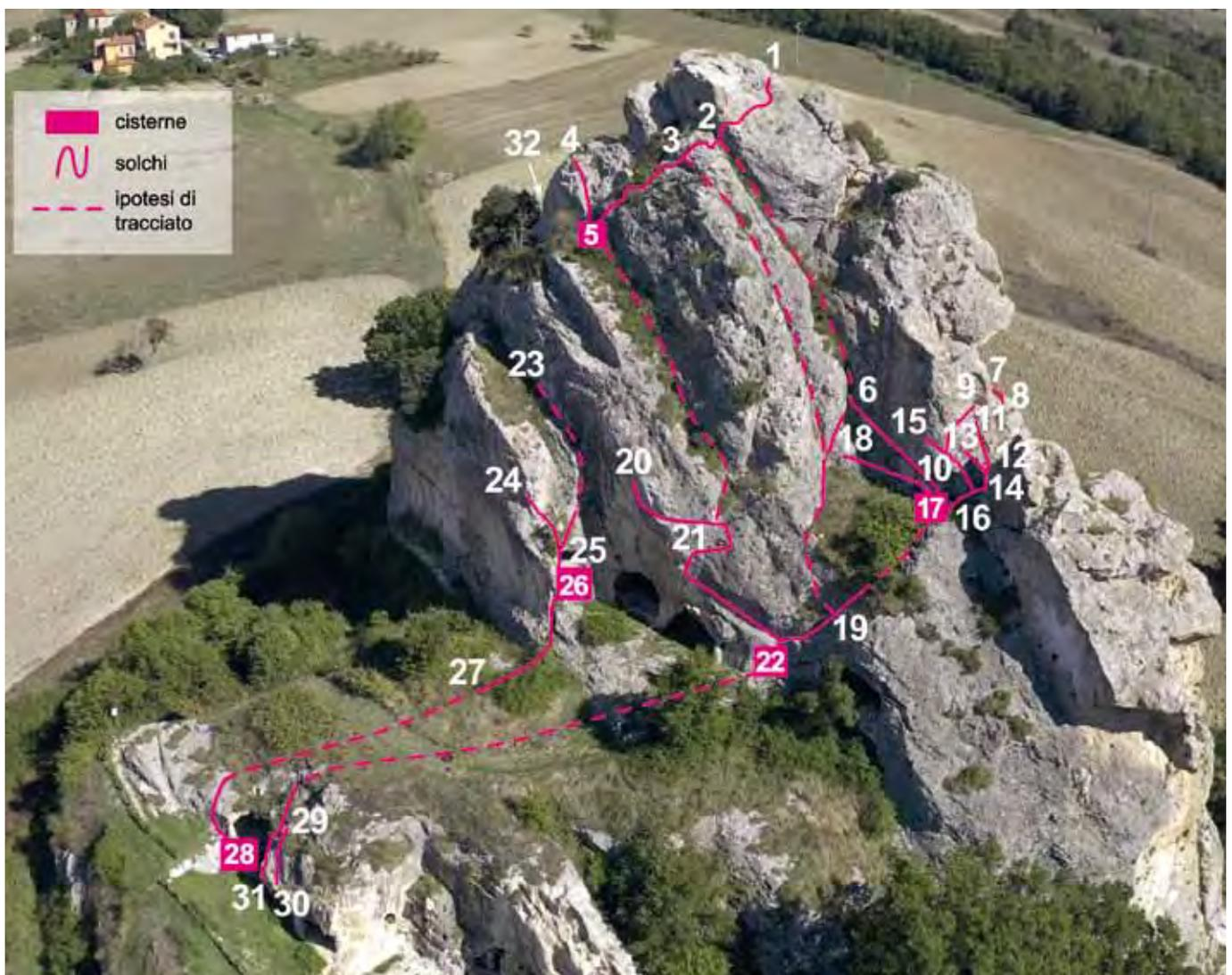
Fig. 2 – Sistema di intercettazione, canalizzazione e accumulo delle acque meteoriche nella morgia di Pietravalle (elaborazione grafica: A. Capozzi, C. Ebanista, M. Mancini).
