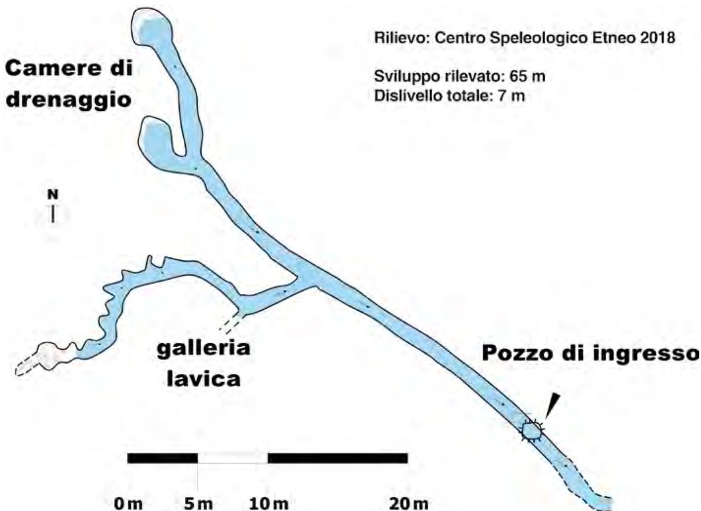
Fig. 4 – Pianta del qanat di Cifali (grafica G. Giudice - rielaborazione rilievo A. Marino 2004).
