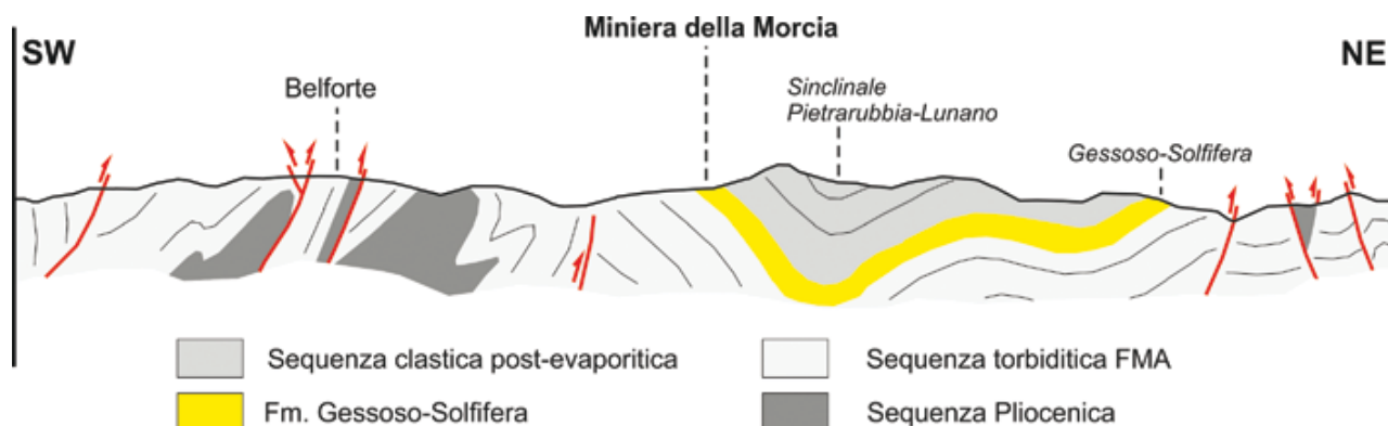
Fig. 6 - Sezione geologica schematica della sinclinale interna Pietrarubbia-Lunano (disegno A. Tamburini).
