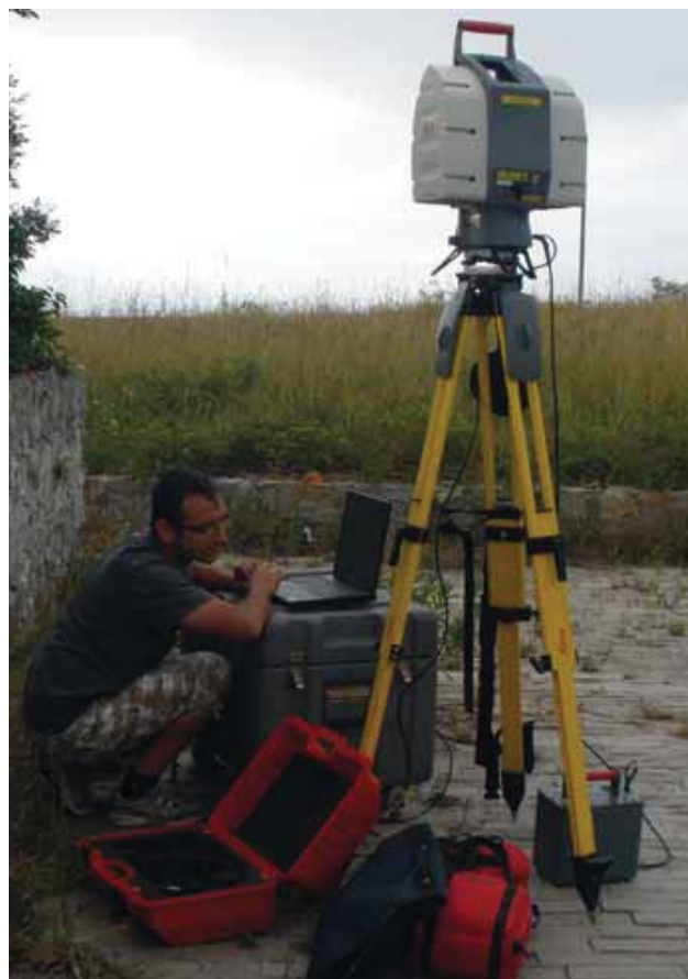
Fig. 15 - L'acquisizione dei dati di rilievo topografico e architettonico effettuato con scanner laser (foto S. Saj).
