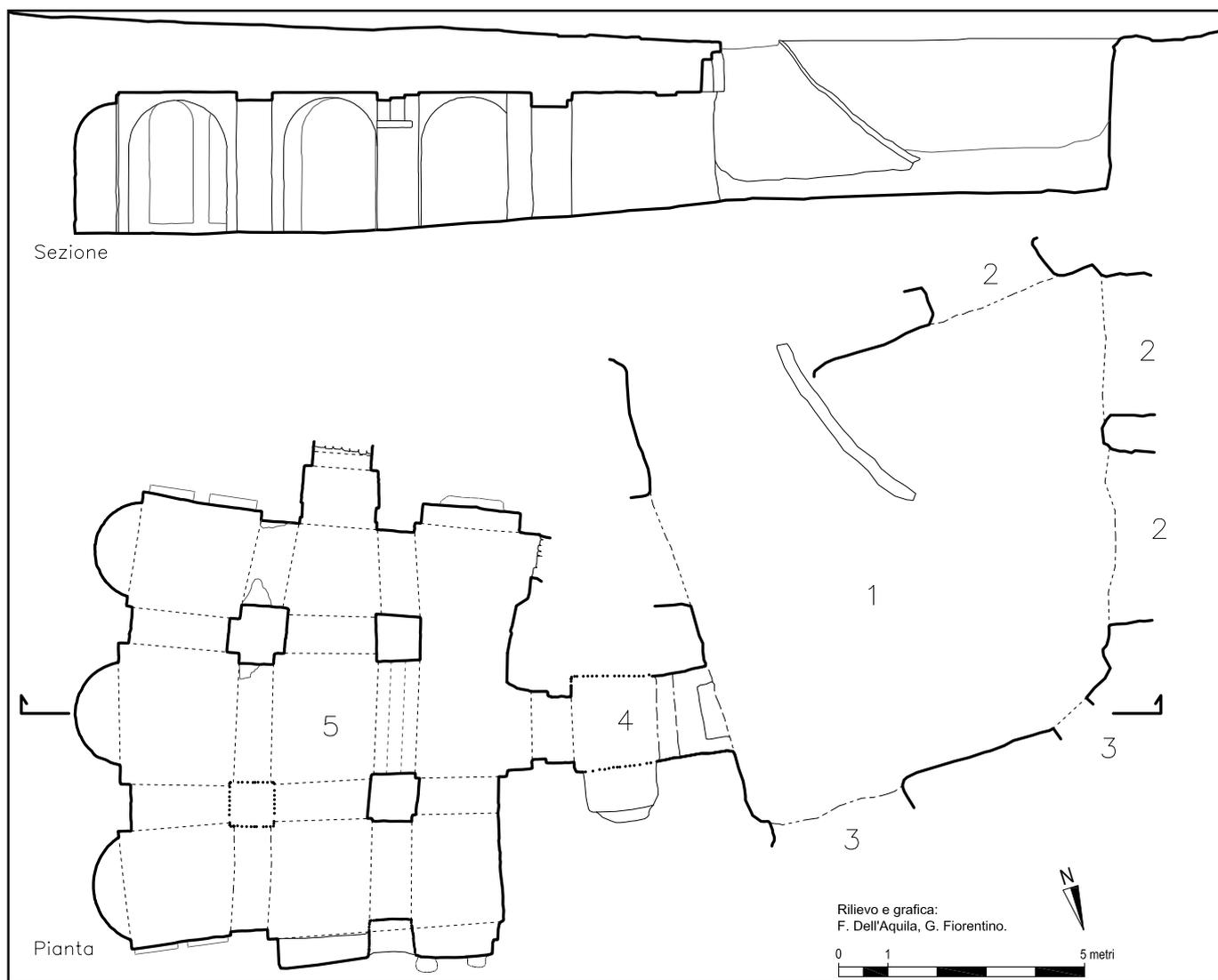
Fig. 1 - Pianta della chiesa rupestre di S. Angelo alla Morsara, Santeramo in Colle, (BA). Pianta e sezione. Legenda: 1) Atrio; 2) Depositi; 3) probabile Abitazione; 4) Narthex; 5) Chiesa. Rilievo e grafica: F. dell'Aquila e G. Fiorentino.
