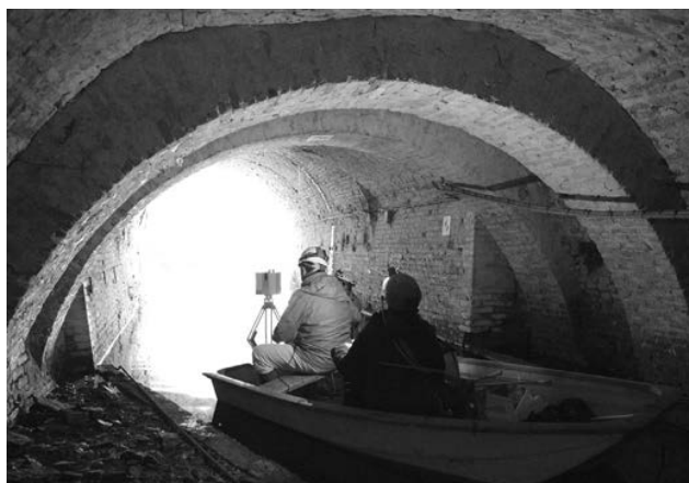
Fig. 17 - Interno sala S01 - fase di rilievo con Laser Scanner 3D (foto Taffurelli L.).
