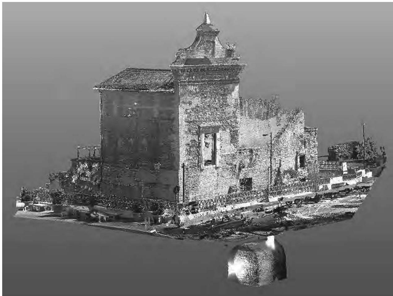
Fig. 7 - Ricostruzione assonometrica dell'area dei Tempietti Romani con posizionamento relativo della cisterna. L'immagine virtuale è ottenuta mediante mesh di punti ricavati con rilievo al laser scanner tridimensionale (elaborazione di A. Natelli).
