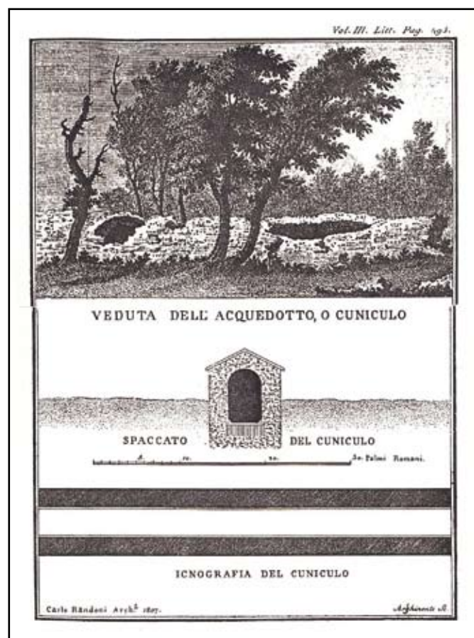
Fig. 2 - Dai rilievi d’inizio Ottocento: veduta, spaccato e icnografia del cosiddetto “Cunicolo” (da FRANCHI DI PONT, 1809. Incisione all’acquaforte di Antonio Argentinetti su disegno di Carlo Randoni, 1807).
