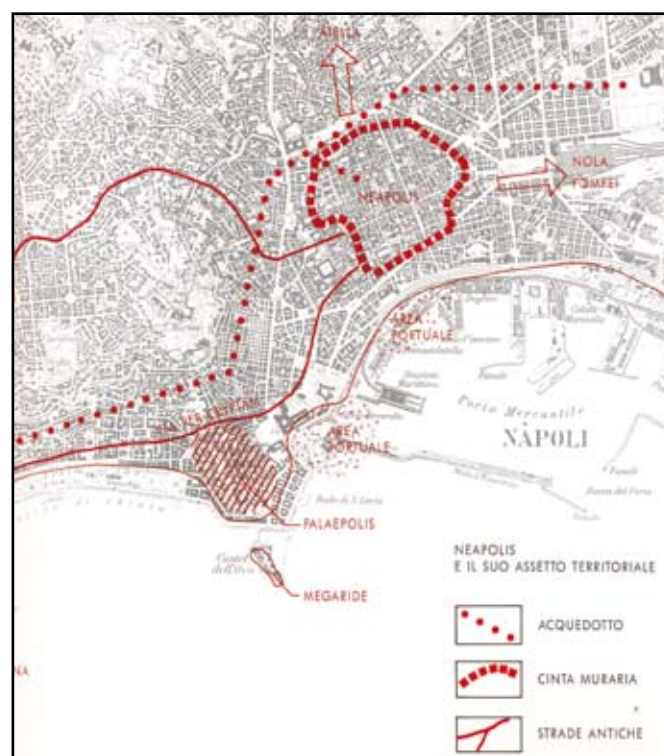
Fig. 3 - Ricostruzione del percorso dell'antico acquedotto romano del Serino nella città di Napoli (da AA.VV., 1994).
