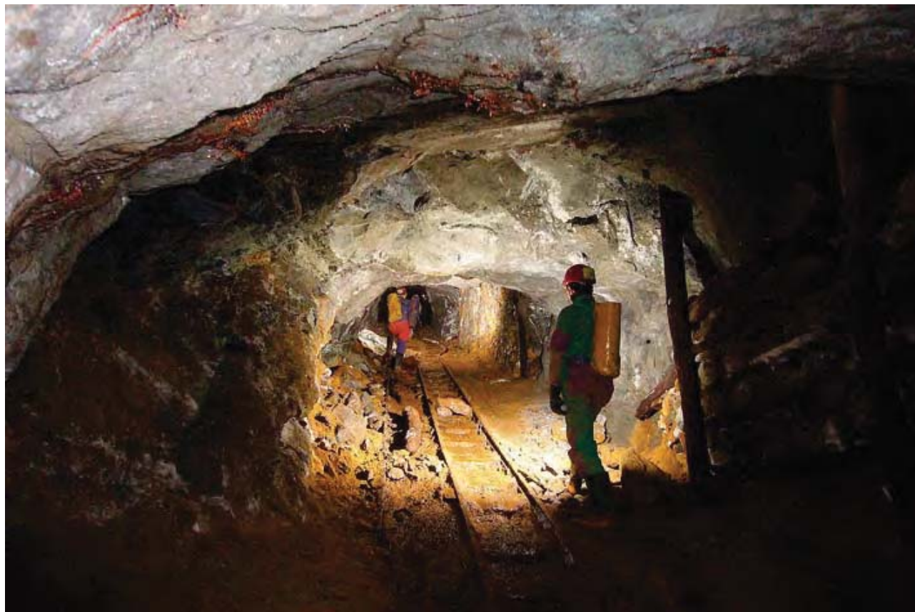
Fig. 6 - Il piano inclinato principale di collegamento fra livelli. Fig. 6 - The “main ramp” connecting underground levels.
