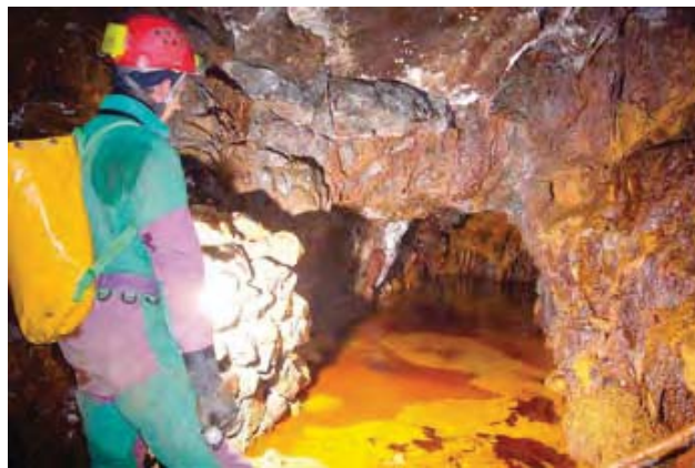
Fig. 7 - Acque rosse per la presenza di solfuri di ferro. Fig. 7 - Red colored waters by iron sulphate.
