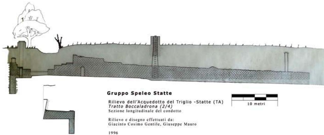
Fig. 2 - Sezione longitudinale di un tratto dell'acquedotto in zona Boccaladrona - Crispiano (Taranto).
