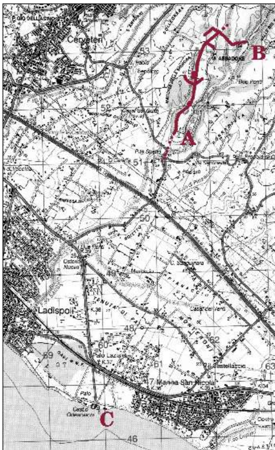
Figura 5 - Carta del territorio attraversata dall'acquedotto. In rosso il tracciato dell'acquedotto etrusco. A: ingresso basso, sul ramo principale Nord-Sud. B: ingresso alto, sul ramo NE. C: presumibile punto di arrivo dell'acquedotto, a servizio dell'antica Alsium , porto meridionale di Caere. Oggi il condotto riesce comunque ad alimentare il Castello degli Odescalchi e la Villa Torlonia, oggi Hotel La Posta Vecchia. (Base IGM 25.000 Foglio 373 Sezione IV).
