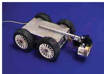
Foto 6: il "rover" con telecamera aggiuntiva montata (foto dell'Autore).
