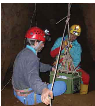
Figure 2, 3, 4 e 5: prova di rumore nella CA270LaRM. Dall'alto: i materiali e gli speleologi all'esterno dell'ipogeo; l'ingresso del cunicolo; la preparazione degli strumenti; il sismometro "profondo" viene calato nel P58 da M. Mazzoli, della ASSO di Roma (foto di C. Germani e A. De Paolis).
