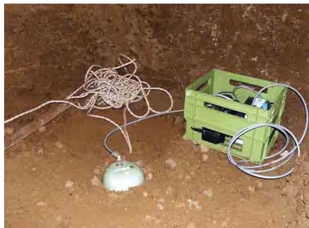
Figura1: prova di rumore nelle CA270LaRM. Il sismometro "alto" (foto C. Germani).
