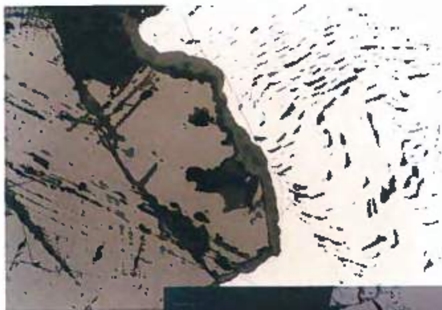
Foto 18: galena (bianca) e blenda (grigia) concrescute e interdigitate. Si vedono le incipienti alterazioni in carbonati, rispettivamente cerussite e smithsonite, lungo i bordi e le fratture. La ganga è costituita da barite e carbonati (5X, N/I), miniera S. Patrizio (foto M.L. Perissinotto).
