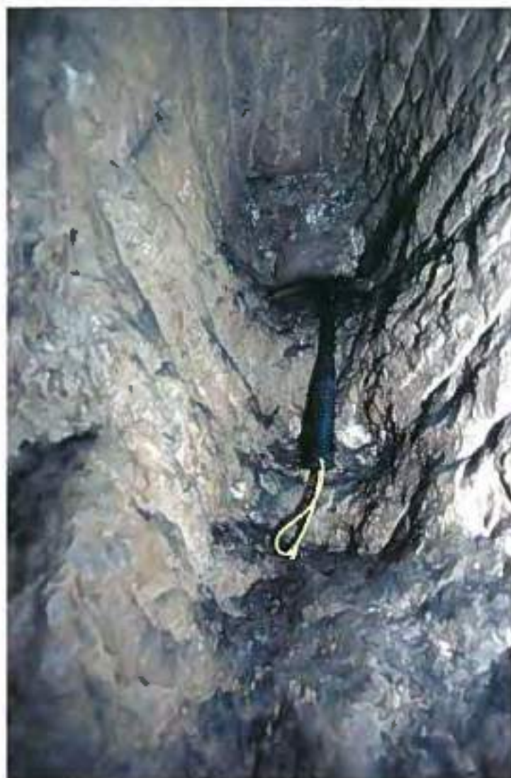
Foto 3: una cecca con i tipici segni della lavorazione a punta e mazza, nella miniera S. Patrizio (foto A. Danieli, Commissione Fotografica della Federazione Speleologica Veneta).
