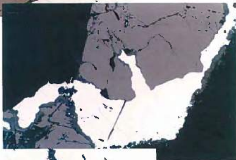
Foto 18: galena (bianca) e blenda (grigia) concrescute e interdigitate. Si vedono le incipienti alterazioni in carbonati, rispettivamente cerussite e smithsonite, lungo i bordi e le fratture. La ganga è costituita da barite e carbonati (5X, N/I), miniera S. Patrizio (foto M.L. Perissinotto).
