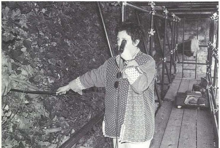
Foto 14: Castello di Torriglia - l'esplorazione di quello che si suppone essere lo spurgo della cisterna sotterranea. Purtroppo, pur riuscendo a far avanzare la sonda per più di tre metri, non è stato possibile raggiungere la cisterna a causa dei detriti (foto di Antonella Pasquale e Daniele Massazza).
