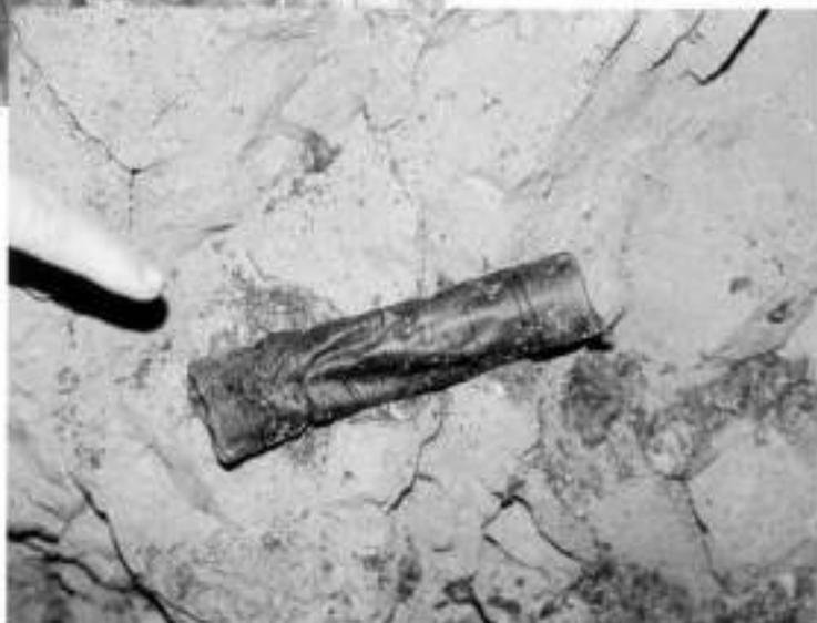
Foto 20a (sopra), 20b (a fianco): candelotto di esplosivo ancora in sede e con la miccia ben evidente (a). Le indicazioni riportate sull'etichetta del candelotto consentono di risalire allo stabilimento di produzione (b) (foto B Bocchino).
