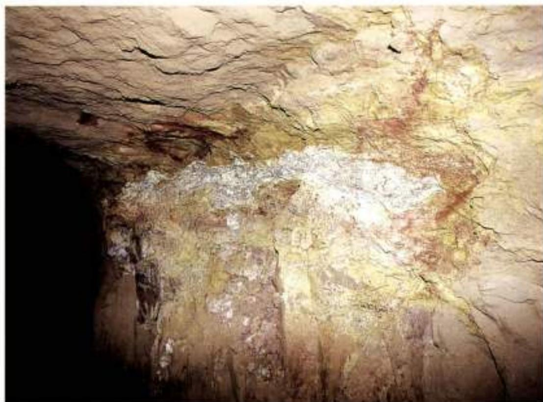
Foto 8: il diverso tenore di allumina e di ossidi ferrosi nella bauxite induce le variazioni cromatiche dal bianco, al giallastro, al bruno rossastro evidenti nella foto (foto F. Alfocca).
