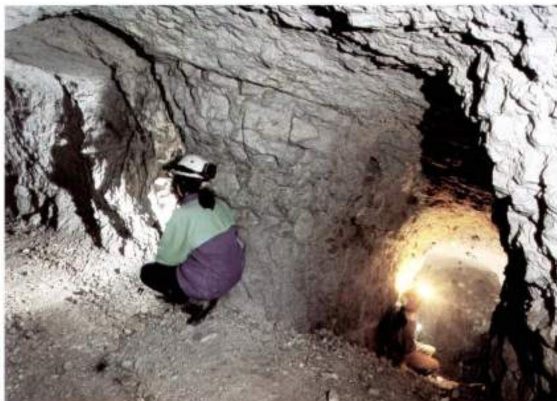
Foto 15: miniera di Fontana di Tasso - intersezione tra il "ramo alto" ed un ramo trasversale. Si noti la netta differenza di pendenza delle due gallerie (foto B. Bocchino).
