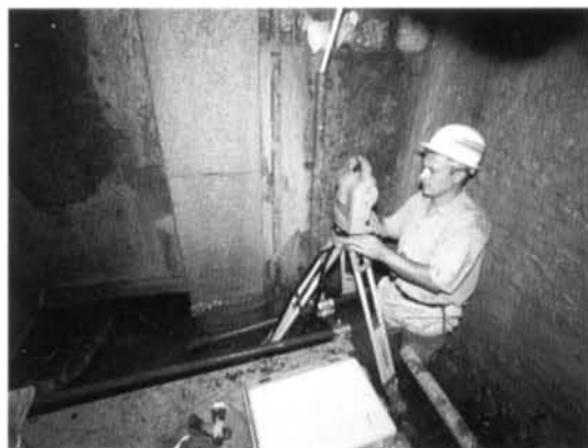
Foto 4: Rilievo interno: installazione della stazione celerimetrica (foto G. Badino).
