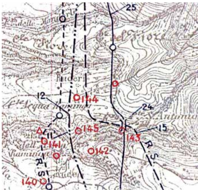
Fig. 1 – Il percorso dei quattro acquedotti Anienesi nel tratto che discende verso il Fosso dell'Acqua Raminga, con indicazione di capisaldi e livellazioni nella pianta tracciata da Ashby (1935).
