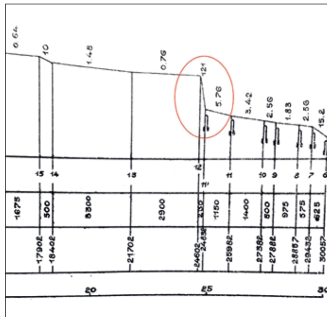
Fig. 2 – Particolare della curva di livellazione dell'acquedotto Marcia disegnata dal Reina (1917).
