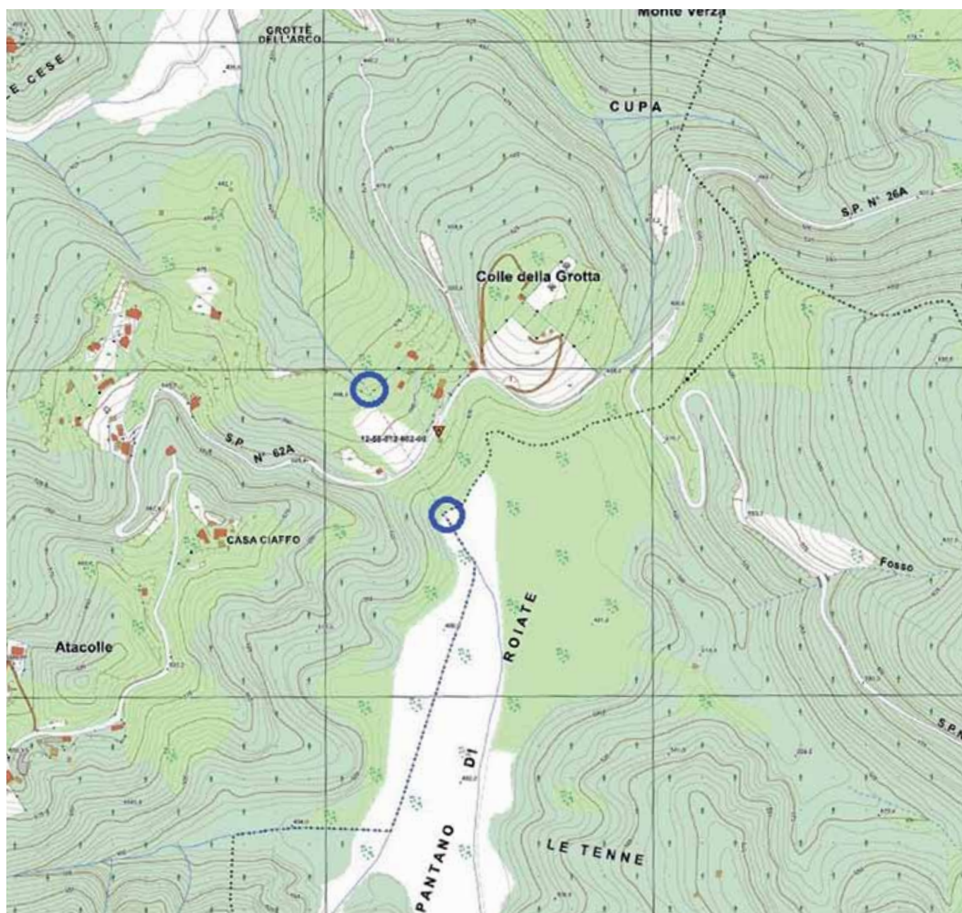
Fig. 10 – L'indicazione del Traforo, in tratteggiato, nella Carta Tecnica della Regione Lazio; indicazioni degli autori con cerchi blu dell'entrata e dell'uscita del tunnel.
